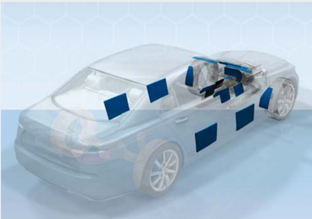
Dämpfungsfolien – hier in Türen, Dach und Boden – mindern den Körperschall sehr wirkungsvoll und kommen inzwischen in allen Fahrzeugsegmenten zum Einsatz.
